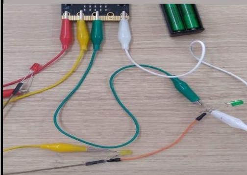
Por fim, as ligações são feitas em sequência. Importante que todas as pernas menores do led (negativa) estejam conectadas, fazendo uma ligação em rede. Isso se faz com o jumper, na última conexão, como na imagem acima, o Led verde, juntos o jumper e o jacaré
